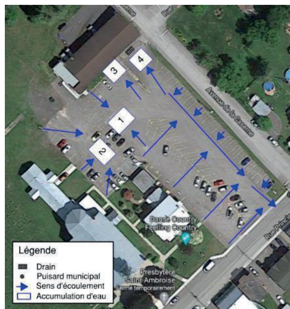
Figure 2 Gestion des eaux pluviales et accumulation d'eau
